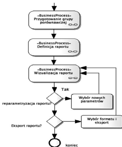
Rys. 4. Diagram BPMN ilustrujący czynności prowadzące do przygotowania raportu w systemie
